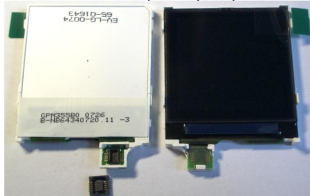
Рис.2. Жидкокристаллический индикатор с контроллером S1D15G00 фирмы Epson
