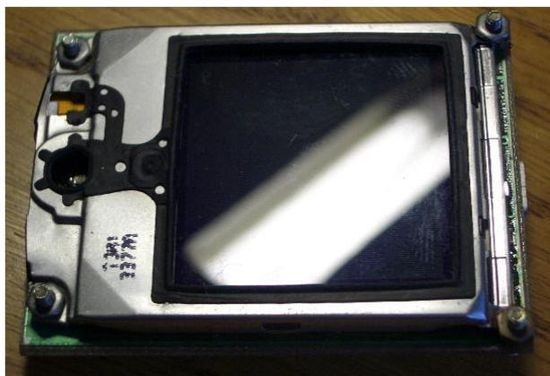
Рис.4. Жидкокристаллический индикатор с крепежной рамкой, укрепленный на печатной плате контроллера
